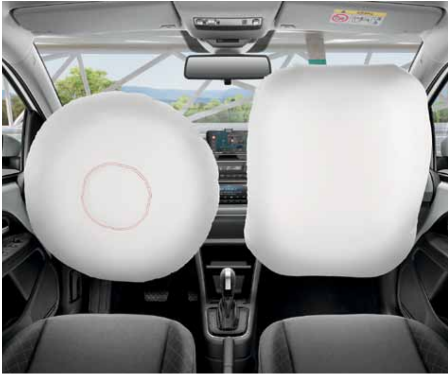
ΕΜΠΡΟΣ ΑΕΡΟΣΑΚΟΙ Μεγάλου όγκου αερόσακοι οδηγού και συνοδηγού, ενεργοποιούνται σε συνδυασμό με τους εμπρός προεντατήρες ζωνών ασφαλείας, που σας σταθεροποιούν στην κατάλληλη θέση στο κέντρο του καθίσματος.
