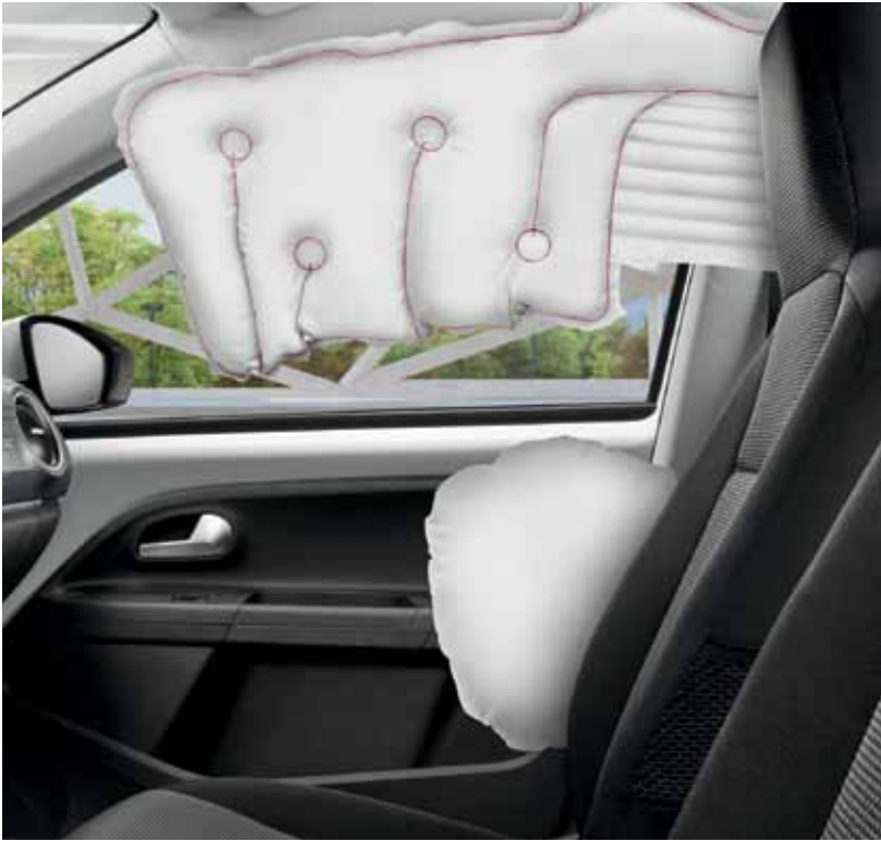
ΠΛΕΥΡΙΚΟΙ ΑΕΡΟΣΑΚΟΙ Αυτοί οι αερόσακοι προστατεύουν το κεφάλι και το σώμα όσων κάθονται στα εμπρός καθίσματα σε μία πλευρική σύγκρουση.
